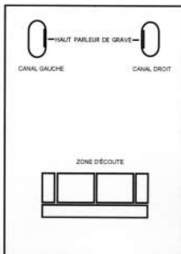
c'est à dire face à face. Dans certain cas de pièce réverbérante et dont les murs latéraux sont éloignés de plus d'un mètre des enceintes, il est possible d'inverser la position des enceintes. Nous vous conseillons de faire le test attentivement sur plusieurs disques.
